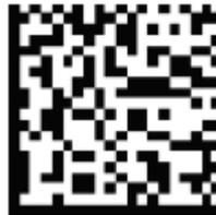
O Datamatrix ECC 200 é a única configuração Datamatrix que emprega sistematicamente a correção de erro, chamada de correção de erro Reed-Solomon.
